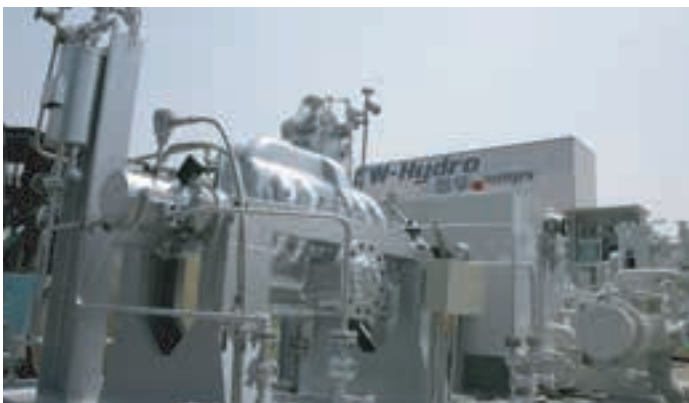
SPEC : 309.6m 3 /hr x 505m x 650kW (Turbine)
