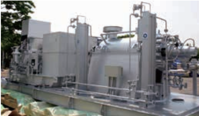
SPEC : 514.8m 3 /hr x 1563m x 3000kW (Turbine)
