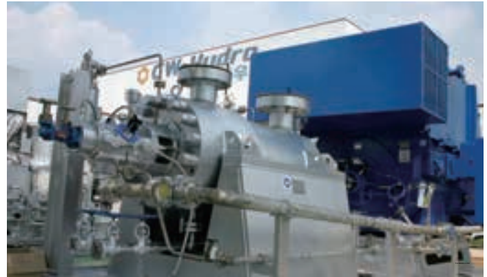
SPEC : 514.8m 3 /hr x 1563m x 3000kW (2Pole)
